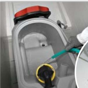
El diseño especial del tanque asegura una descarga completa en el enjuague final
