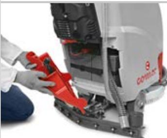
El acceso al habitáculo baterías es simple y rápido. A pedido en los modelos L20 B se pueden instalar las siguientes baterías:
