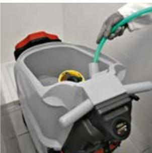
Para obtener óptimos resultados de limpieza y secado es importante mantener limpio el filtro y el tubo de aspiración conectado a la boquilla de aspiración
