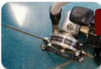
KIT DE ABUJARDAR ESPECIAL PARA ABRIR JUNTAS
